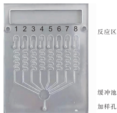
图 1 微流控芯片设置
